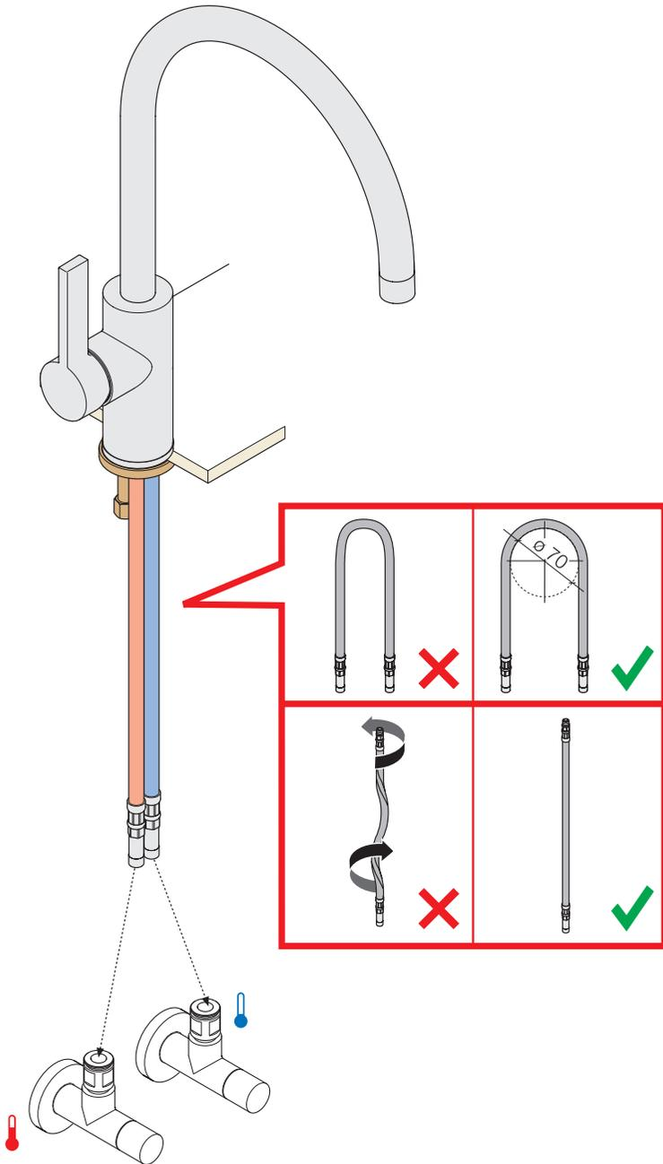
**Bei Montage Ø 35 mm // 35 mm diameter for assembly // Bij montage diameter 35 mm // Pour diamètre de montage 35 mm // Con 35 mm diámetro de montaje // Al montaggio diametro 35 mm // 35 mm diameter for assembly // Vid montering diameter 35 mm // Při montáži průměr 35 mm // Przy montażu Ø 35 mm // При монтаже диаметр 35 мм // 安裝直径为35 毫米**
