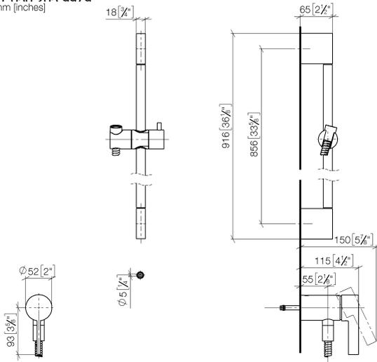
**UP-Einhandbatterie mit integriertem Brauseanschluss mit Duschgarnitur -
