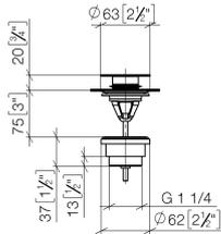
**Garniture d'écoulement avec fermeture à pression 1 1/4" - Dark Platinum
