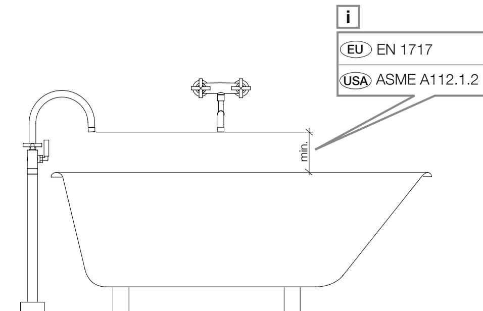
**Montagevarianten** // Assembly versions // Montagevarianten // Variantes de montage //
