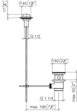
Garniture d'écoulement avec bouton à tirer pour montage sur gorge 1 1/4" -
