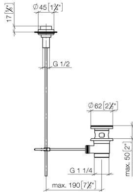
**Garniture d'écoulement avec bouton à tirer pour montage sur gorge 1 1/4" -
