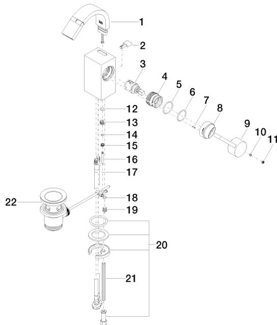
Mitigeur monocommande de bidet avec garniture d'écoulement - Champagne SERIES SPECIFIC
