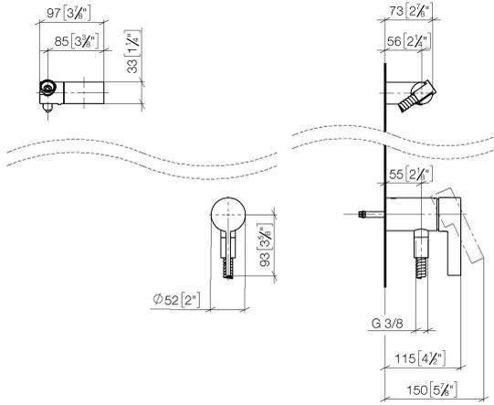
**Mitigeur monocommande encastré avec raccord de douche intégré avec
