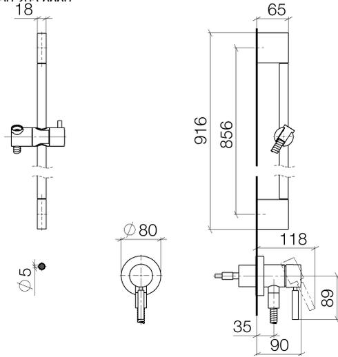
Mitigeur monocommande encastré avec raccord de douche intégré avec
