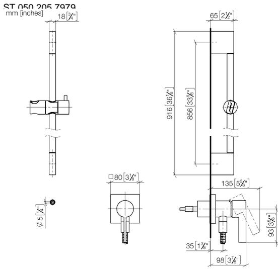
Mitigeur monocommande encastré avec raccord de douche intégré avec
