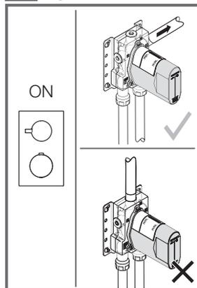
DE Montagebeispiele. GB Installation examples. NL Montagevoorbeelden. FR Exemples de montage. IT Esempi di montaggio. ES Ejemplos de montaje. US Installation Examples. SE Monterings exempel. CZ Příklady montáže. PL Przykłady montażu. RU Примеры монтажа. CN 安装范例。
