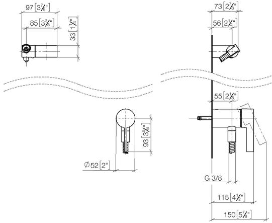
**UP-Einhandbatterie mit integriertem Brauseanschluss mit Handbrausegarnitur
