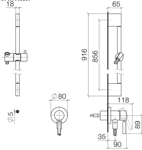
**UP-Einhandbatterie mit integriertem Brauseanschluss mit Duschgarnitur -
