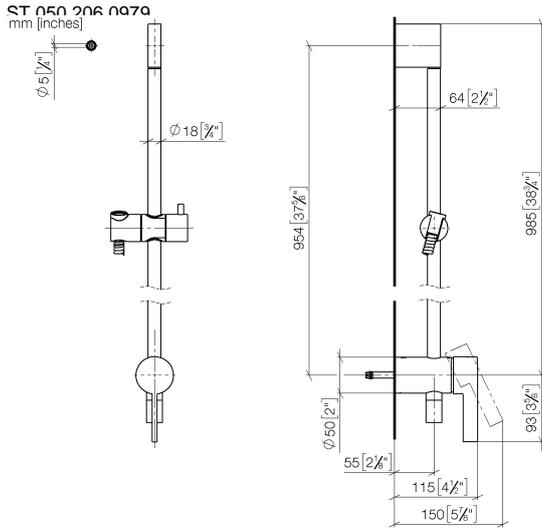
Mitigeur monocommande encastré avec raccord de douche intégré avec
