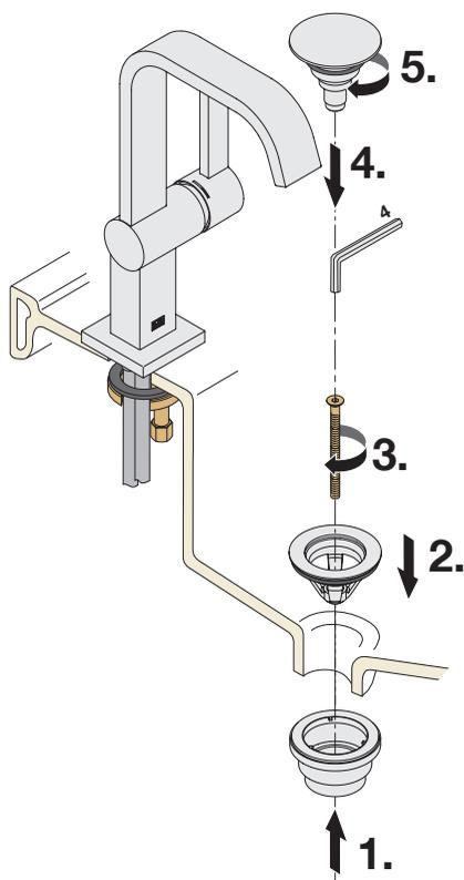
**DE** Bei Montage  $\varnothing < 35$  mm. **GB**  $< 35$  mm diameter for assembly. **NL** Bij montage diameter  $< 35$  mm. **FR** Pour diamètre de montage  $< 35$  mm. **IT** Con  $< 35$  mm diámetro de montaje. **ES** al montaje diámetro  $< 35$  mm. **US**  $< 35$  mm diameter for assembly. **SE** Vid monterings diameter  $< 35$  mm. **CZ** Při montáži průměr  $< 35$  mm. **PL** Przy montażu  $\varnothing < 35$  mm. **RU** При монтаже диаметр  $< 35$  мм. **CN** 安装直径为  $< 35$  毫米。
