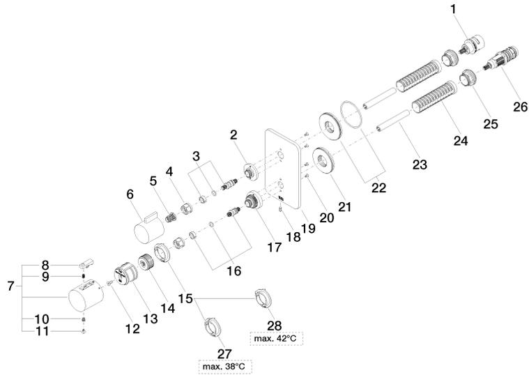
**LISSE Termostato incasso con regolazione di portata dell'acqua ad una via -
