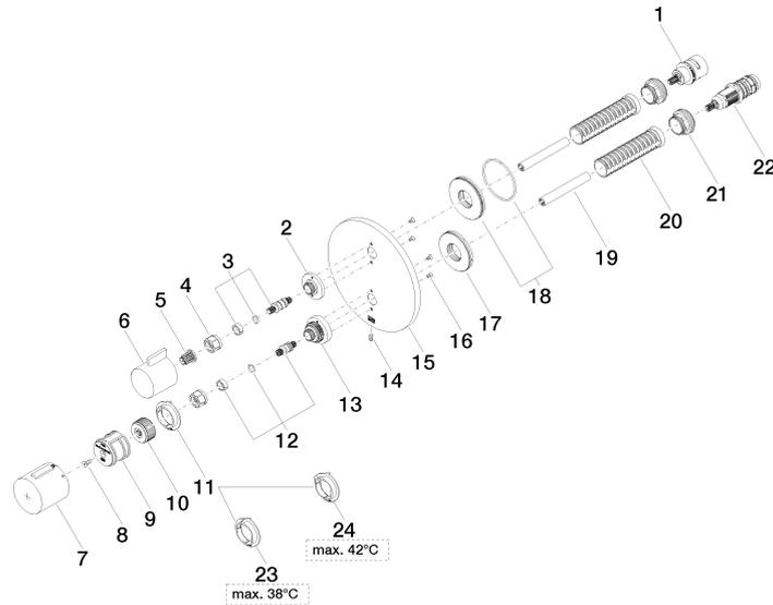
Termostato incasso con regolazione di portata dell'acqua ad una via -
