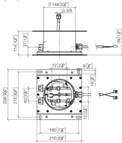
UP-Deckeneinbaukasten für Deckenanbindung mit Licht -
