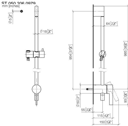
**UP-Einhandbatterie mit integriertem Brauseanschluss mit Duschgarnitur -
