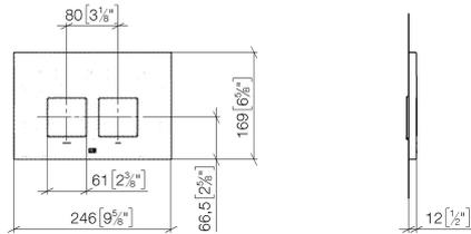
Platine de commande pour réservoir de chasse d'eau à encastrer de la société **SERIES SPECIFIC**
