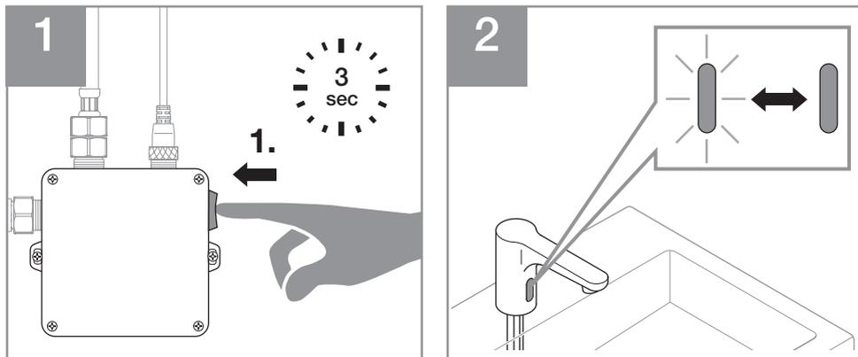
DE Sensoreinstellung. GB Sensor adjustment. NL Sensor instellen. FR Réglage du capteur.
