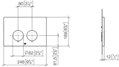
Platine de commande pour réservoir de chasse d'eau à encastrer de la société **SERIES SPECIFIC**
