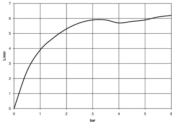
META Mitigeur monocommande de lavabo avec garniture d'écoulement -
