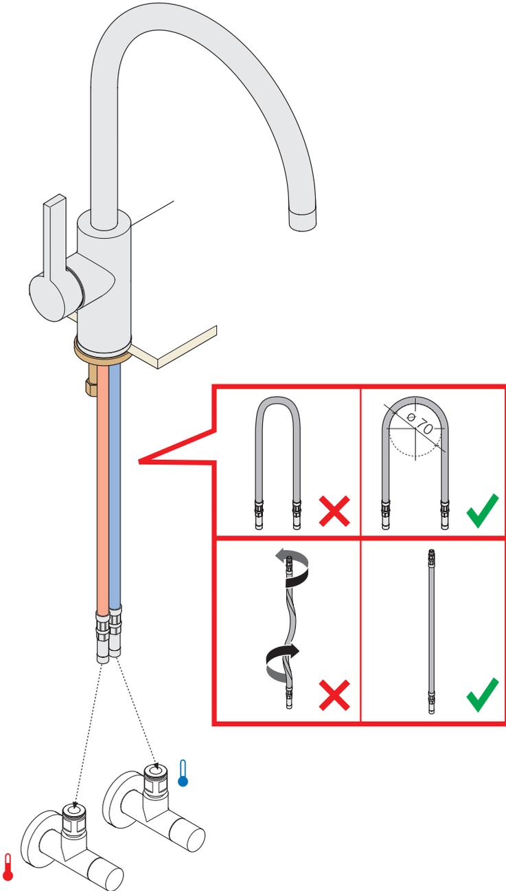
**Bei Montage Ø 35 mm** // 35 mm diameter for assembly // Bij montage diameter 35 mm // Pour diamètre de montage 35 mm // Con 35 mm diámetro de montaje // Al montaggio diametro 35 mm // 35 mm diameter for assembly // Vid monterng diameter 35 mm // Při montáži průměr 35 mm // Przy montażu Ø 35 mm // При монтаже диаметр 35 мм // 安裝直径为35 毫米
