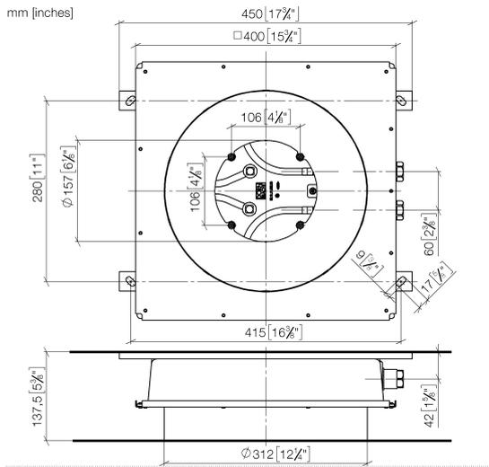
**Scatola di installazione a soffitto UP per installazione a controsoffitto -**
