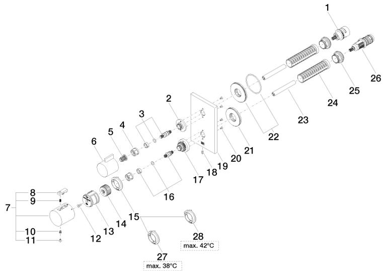
Termostato incasso con regolazione di portata dell'acqua ad una via - Dark
