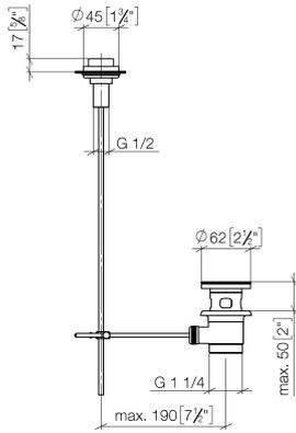
Válvula semiautomática con tirador para montaje sobre encimera 1 1/4" -
