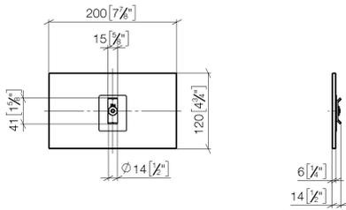
Juego de fijación para montaje a panel de cristal por un lado -
