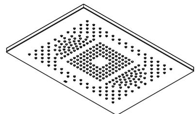
Deckenmodul mit Lichtcontroller und LED
